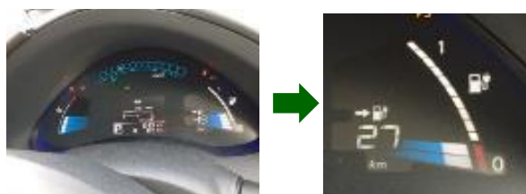
図 3.2.2 EV における LiB パック残容量確認イメージ
