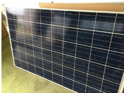
写真 4.2.1 外観検査不合格となった PV モジュール (表面に無数のひび割れあり)
