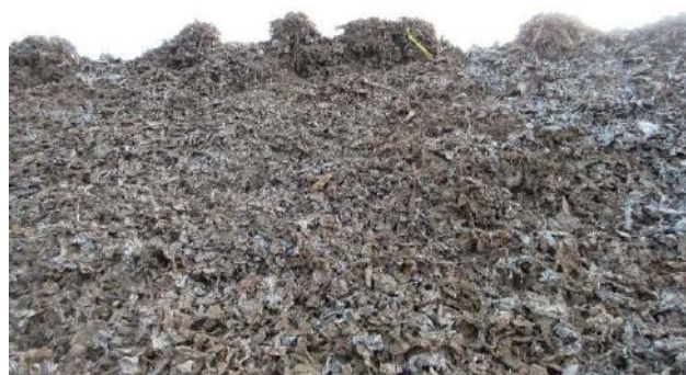
シュレッダーくずの山。不純物を取り除くため、二度破碎処理している
