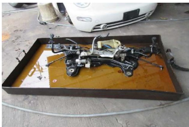
廃オイル対策を講じている様子 （修理（個人）業者）
