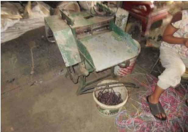
被覆銅線選別機の様子（スクラップ業者）
