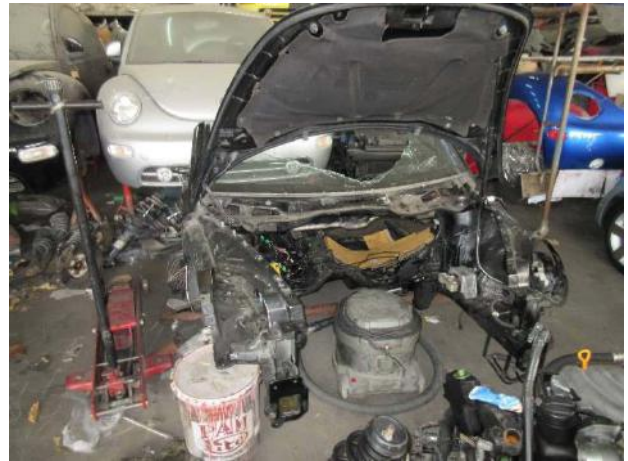
修理している車両（取り出したエンジンを左車両のエンジンへ載せ換える）2
