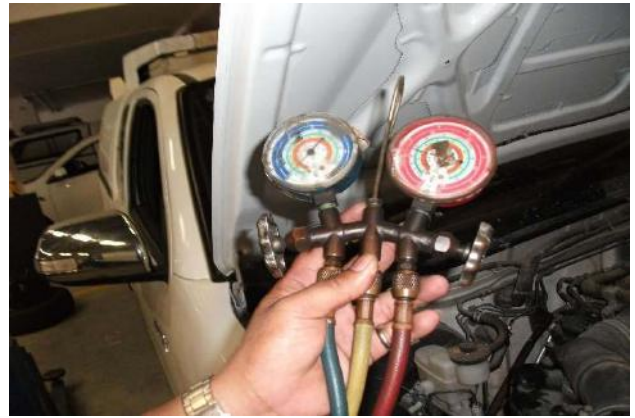
冷媒ガス作業に使用されているマニホールド （レンタカー会社の整備場）
