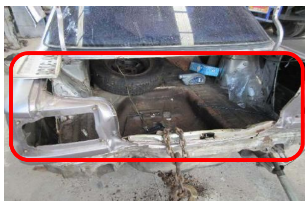
赤線部分を切断し、左写真の車両に替える
