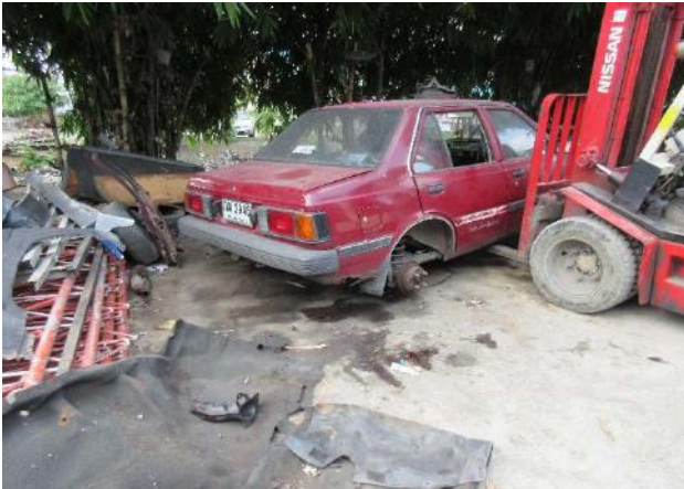
廃液が漏れている様子（解体業者）
