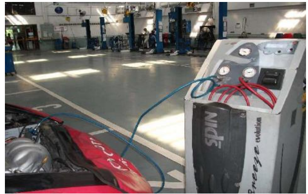
フロン充填機（メーカー系整備業者）
